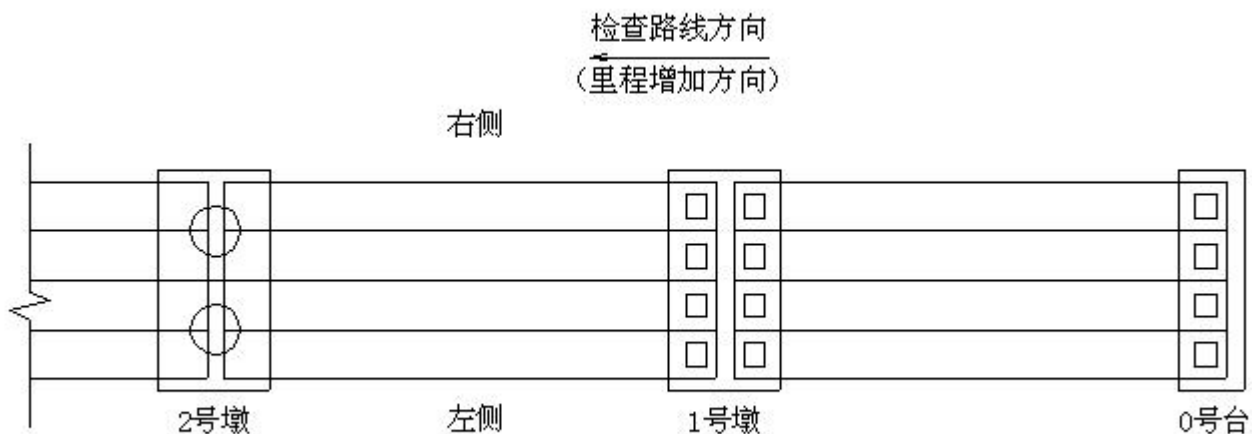
图 2-2 旧桥定期检查顺序示意简图
