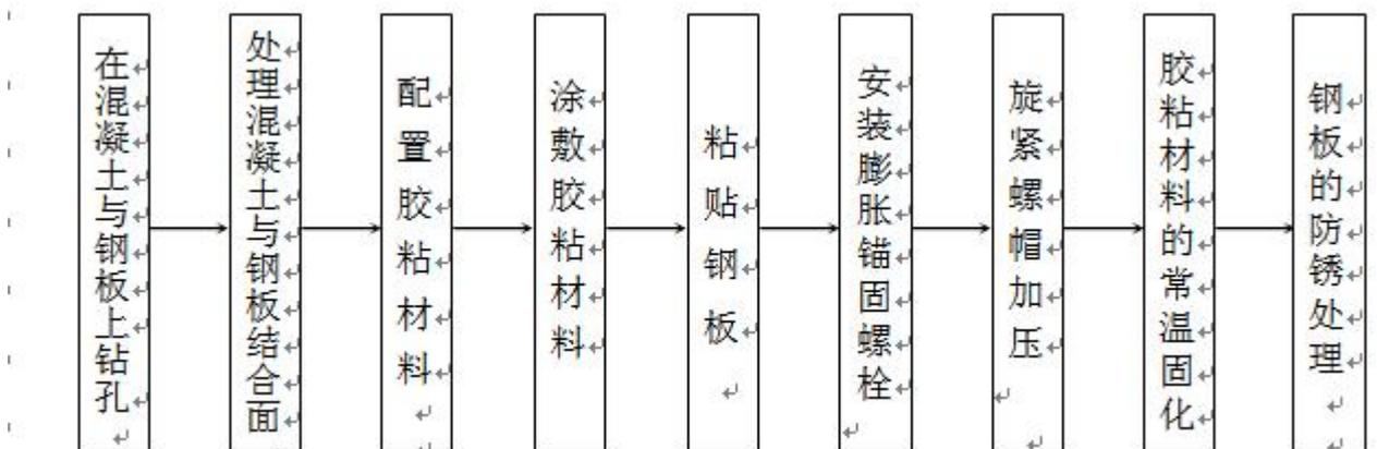
图 7-6 粘贴钢板加固对策施工流程
